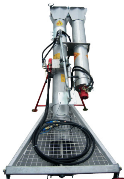
Overlaadschroef Ø 200 mm. opklapbaar in RVS
